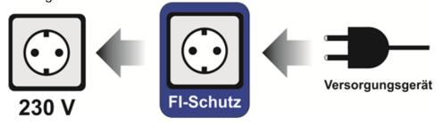
Illustration: Respectez l'ordre: Connecteur intermédiaire pour protection individuelle FI dans la prise secteur Appareil d'alimentation dans la connexion du connecteur intermédiaire FI pour protection individuelle.
