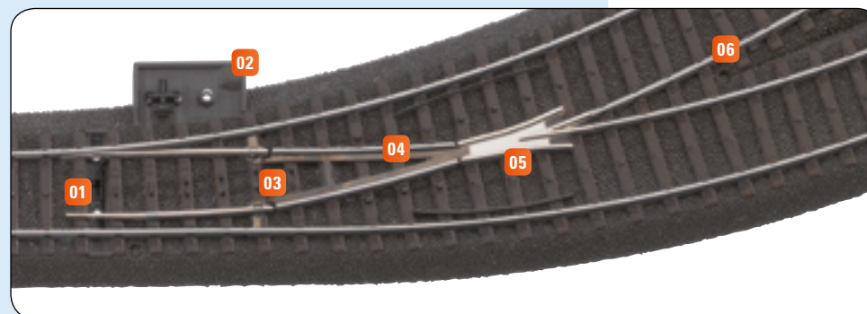
01 Agujas de desvío de fundición con apoyo individual 02 Revestimiento en mecanismo de mando de desvío, como en el modelo real 03 Contacto ininterrumpido desde las agujas hasta el corazón 04 Carriles intermedios de material perfilado 05 Corazón utilizado de metal 06 Curva de desvío como segmento circular de 30°, radio 360 mm
